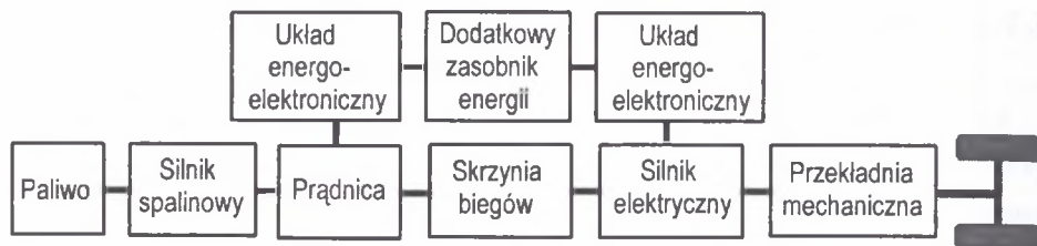
Rys. 4. Topologia równoległa napędu pojazdu hybrydowego Fig. 4. Parallel topology of hybrid vehicle drive
