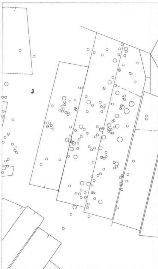
Rys. 1. Eksploatacja w pokładzie 713/1-2 z naniesionymi ogniskami wstrząsów Fig. 1. Mining in the seam 713/1-2 with marked tremor foci
