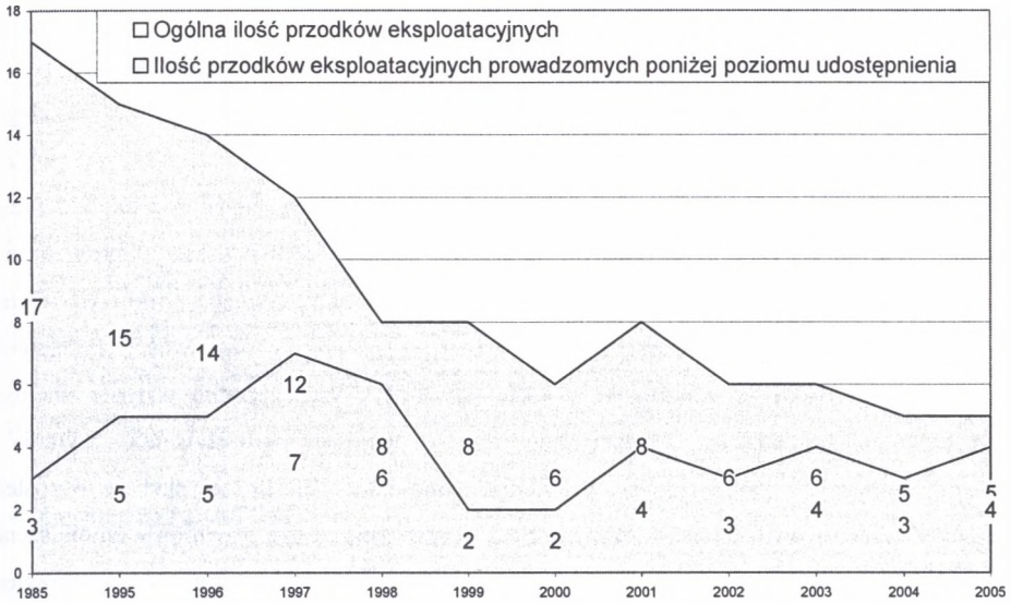
Rys. 4. Liczba przodków wydobywczych w KWK Bolesław Śmiały ogółem i „poniżej poziomu udostępnienia” w 1985 i w latach 1995–2005
