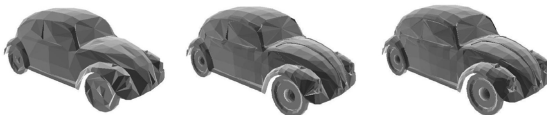
Rys. 11. Wielorozdzielcza analiza nieregularnych siatek 3D (badania własne) Fig. 11. Multiresolution analysis of irregular mesh 3D (personal research)
