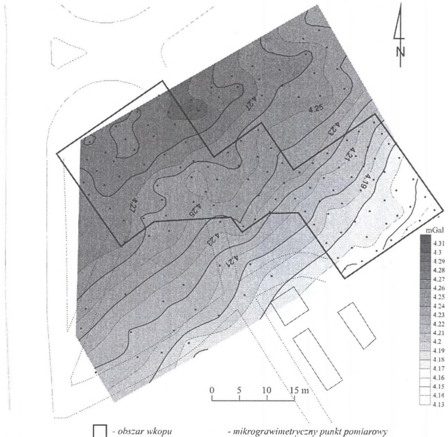
Rys. 3.8. Rozkład anomalii siły ciężkości w redukcji Bouguera
