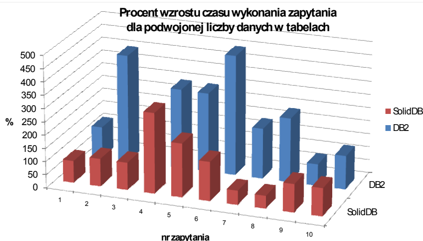
Rys. 7. Procentowy przyrost długości czasu wykonania zapytania dla dwukrotnie powiększonego zbioru danych baz SolidDB i DB2
