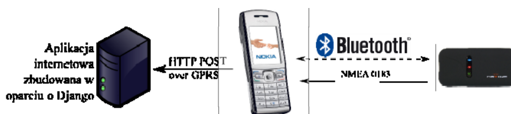
Rys. 5. GPS Tracker – zasada działania
