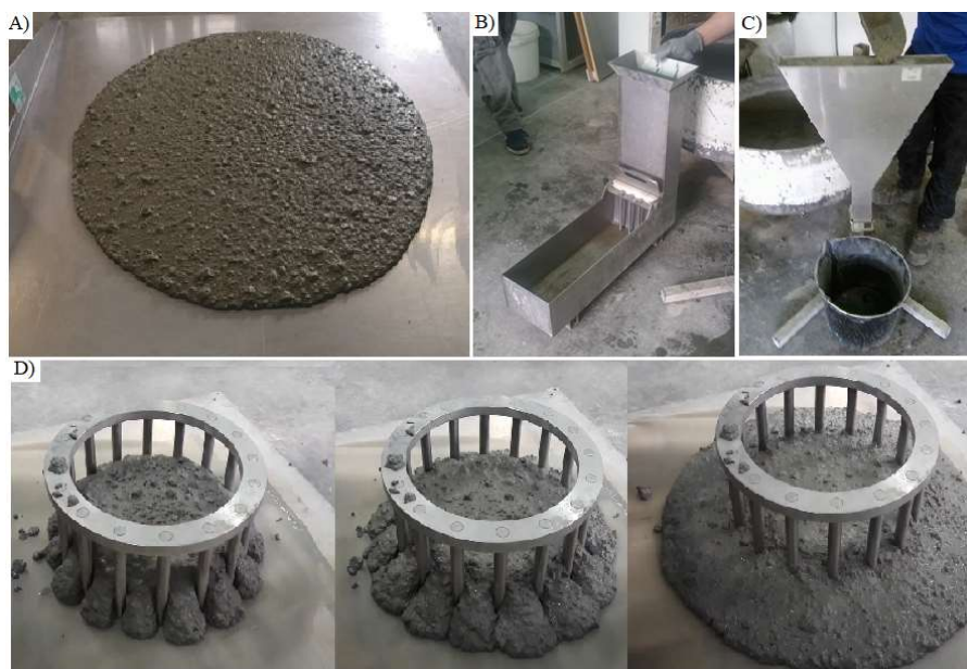
Rys. 60. Metodyka badań właściwości mieszanek betonowych samozagęszczalnych SCC: A) konsystencja metodą rozplywu stożka (PN-EN 12350-8:2012 [142]); B) przeplywalność metodą L-pojemnika - 3 pręty (PN-EN 12350-10:2012 [143]); C) lepkość metodą V-lejka (PN-EN 12350-9:2012 [144]); D) lepkość metodą J-pierścienia - 16 prętów (PN-EN 12350-12:2012 [145])
