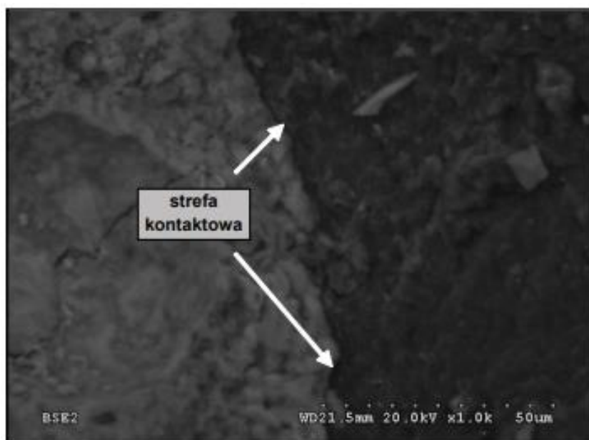
Rys. 2.18. Strefa kontaktowa guma – zaczyn cementowy [Ołdakowska 2012a]
