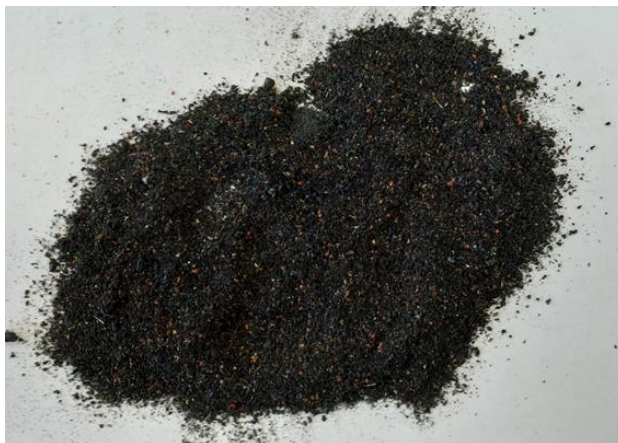
Rys. 3.2. Rozdrobnione odpady gumowe zastosowane w badaniach [fot. własna]
