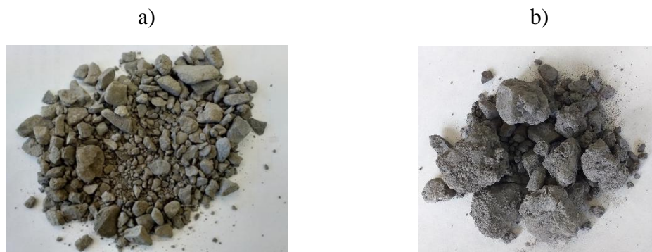
Rys. 3.1. a) Łupek przywęglowy nieprzepalony nr 1; b) łupek przywęglowy nieprzepalony nr 2 [fot. własne]
