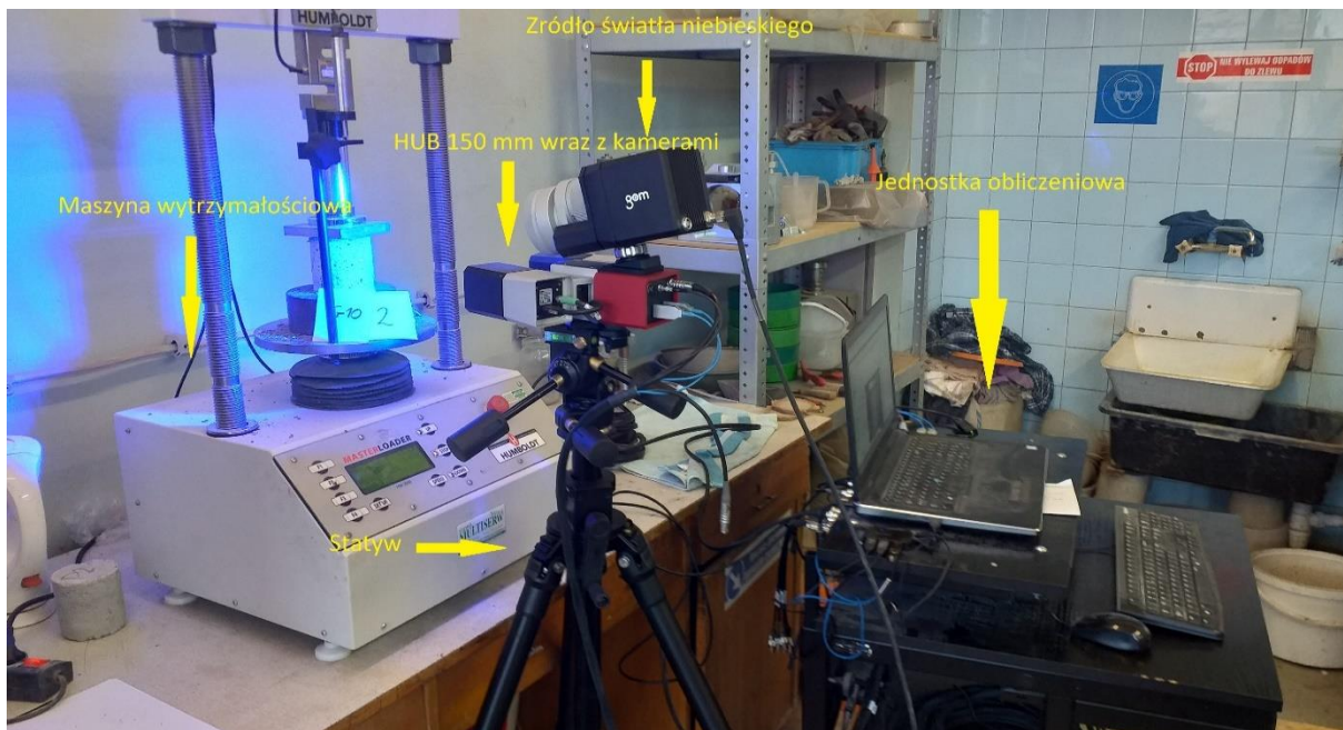
Rys. 2.32. Stanowisko systemu pomiarowego ARAMIS 3D przygotowane do badań [fot. własna]
