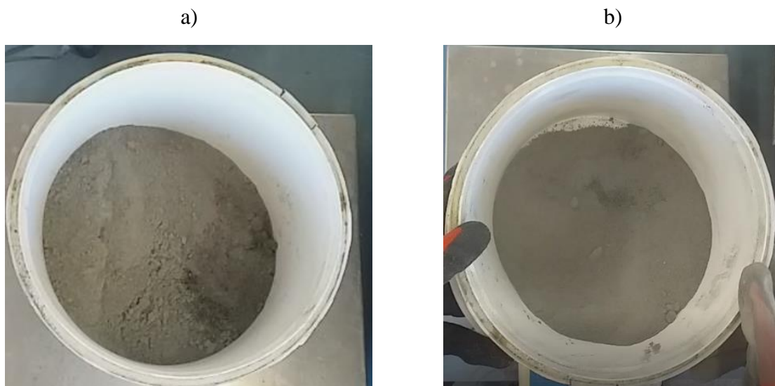
Rys. 3.6. a) Składniki mieszanki przed homogenizacją; b) składniki zhomogenizowane [fot. własne]
