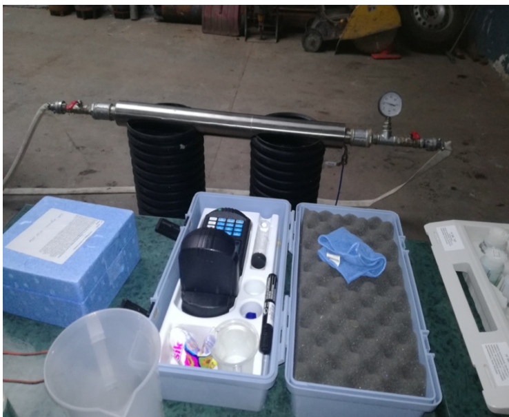
Rys. 24. Laboratoryjne stanowisko badawcze efektywności ozonowania sieci wodociągowej – układ modelowy
