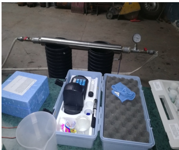
Rys. 35. Stanowisko pomiarowe zawartości ozonu w próbce, kolorymetr HACH DR 890
