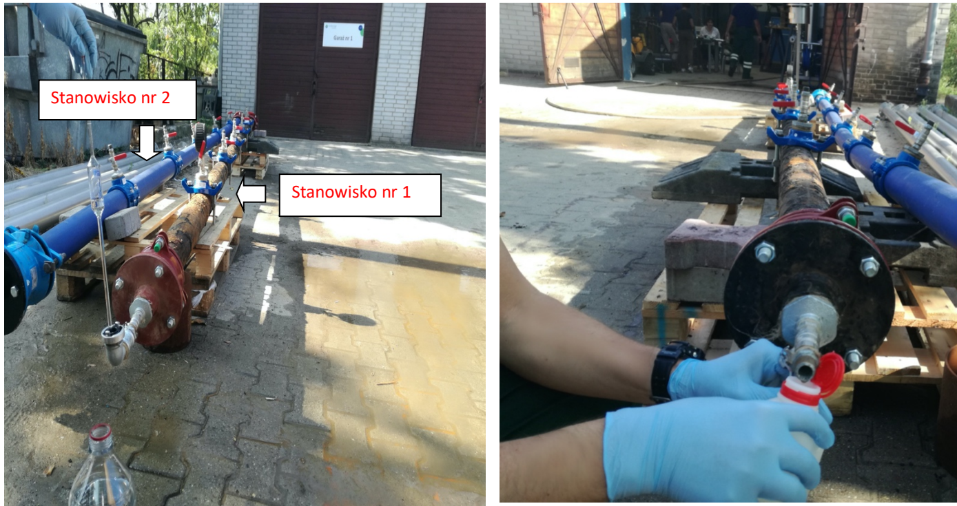
Rys. 26. Stanowisko nr 1 i nr 2 do badań w warunkach ułamkowo – technicznych
