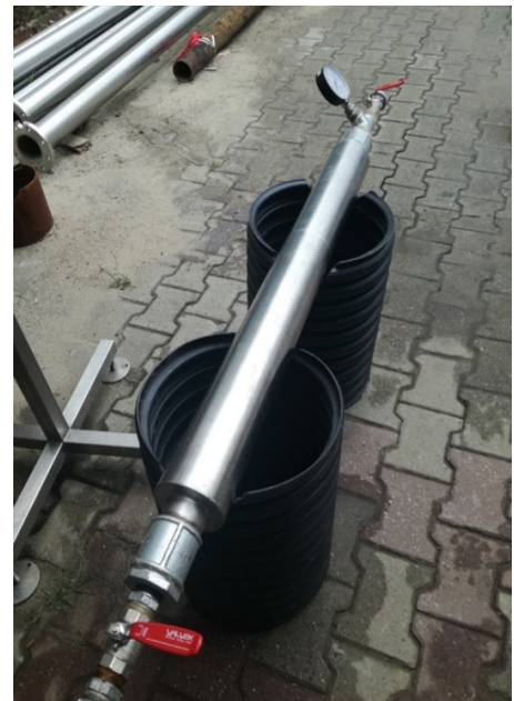
Rys. 24. Laboratoryjne stanowisko badawcze efektywności ozonowania sieci wodociągowej – układ modelowy
