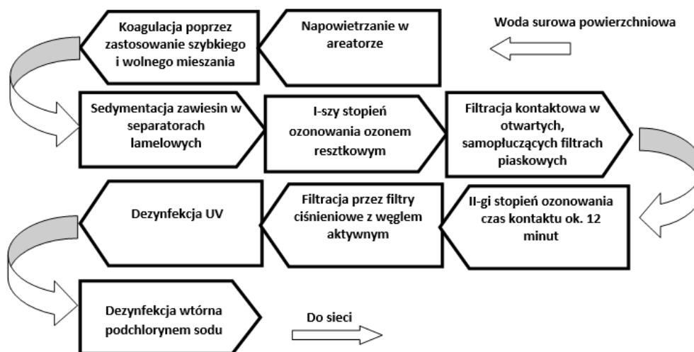
Rys. 6. Schemat blokowy SUW Piaskownia w Jaworznie
