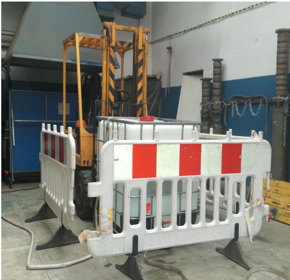
Rys. 28. Paletopojemnik z wodą zasilającą SPID
