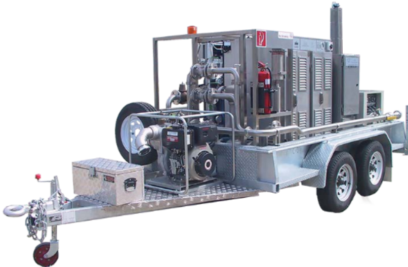
Rys. 21. Mobilny System PDS do dezynfekcji sieci wodociągowej w Sydney [123]
