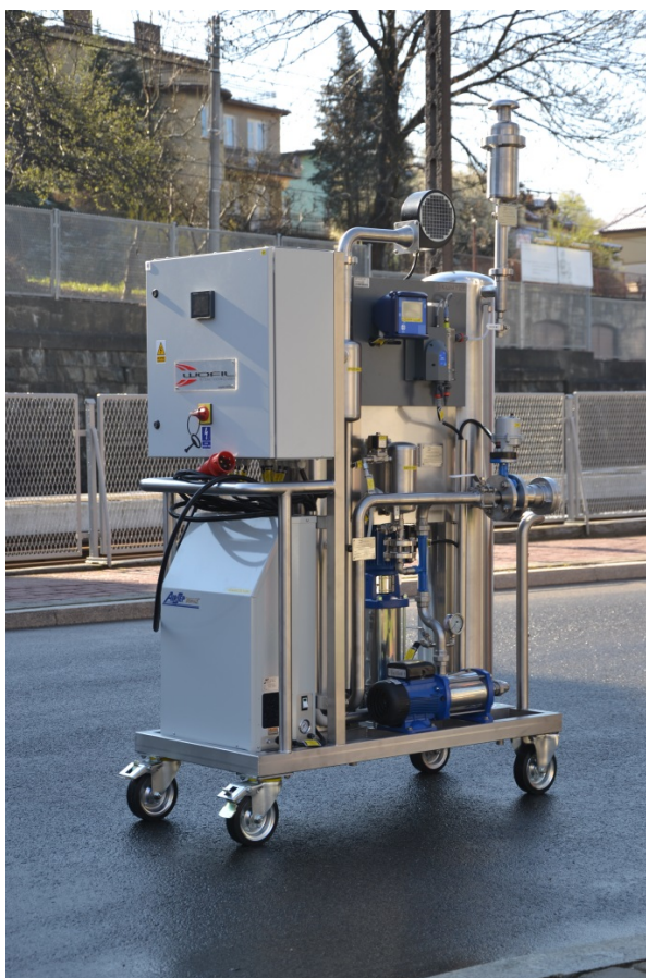
Rys. 19. SPID - mobilne urządzenie do płukania i dezynfekcji sieci wodociągowej
