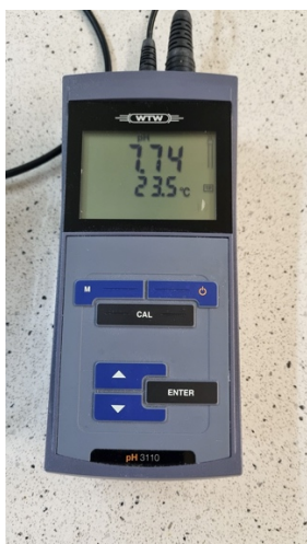
Rys. 33. Przenośny pH-metr laboratoryjny typu pH 3110 ProfiLine produkcji WTW
