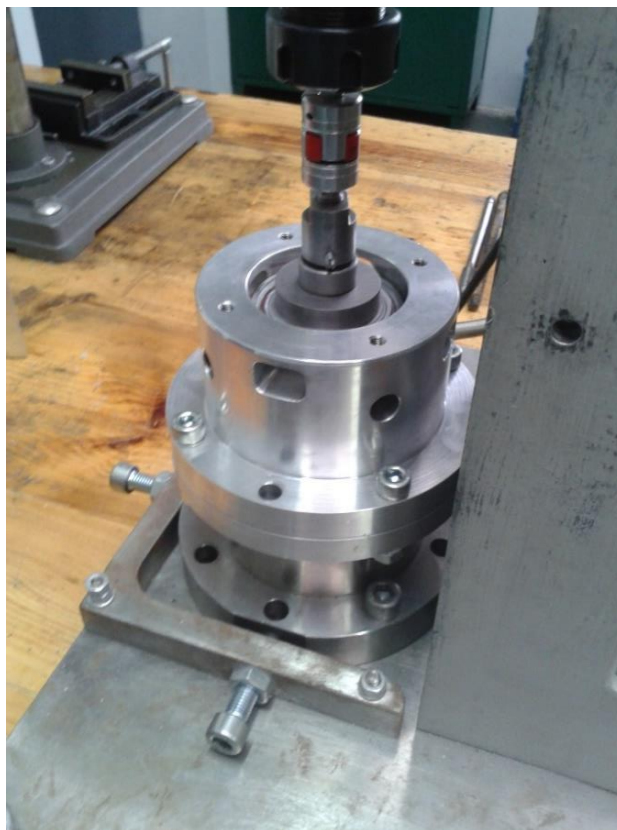
Rys. 7.2. Stanowisko badawcze do pomiarów momentu oporu ruchu łożysk B7007-E-T-P4S
