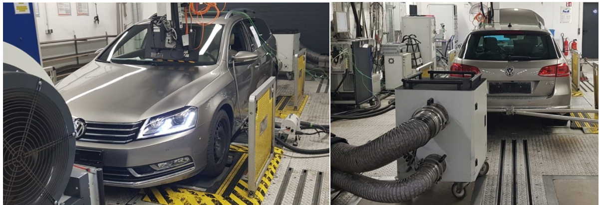
Rys. 23. Przygotowany samochód do badań emisji na hamowni podwoziowej
