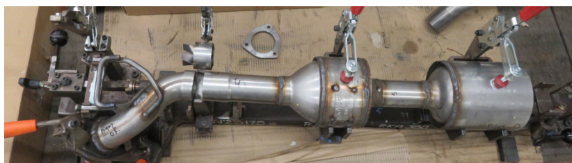
Rys. 3. Sprawdzian w fazie budowy prototypu układu SCR
