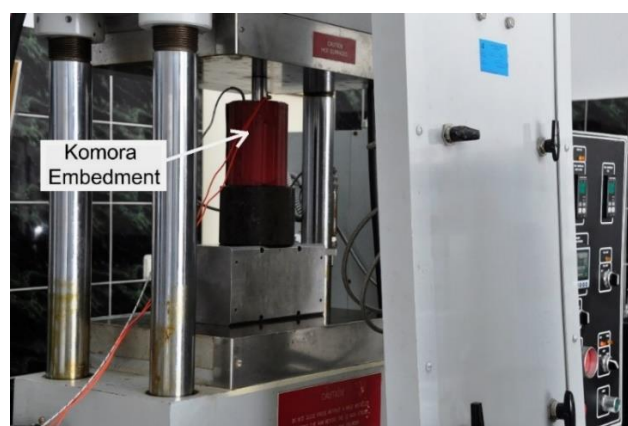
Rys. 3.5 Stanowisko do symulacji zjawiska wgniatania ziaren podsadzki w ścianę szczeliny (Embedment), w INiG-PIB
