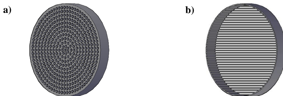
Rys. 5.1. Typowe geometrie regeneracyjnego wymiennika ciepła: a – cylinder nawiercany, b – konstrukcja nacinana.
