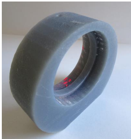
Rys. 5.4. Widok geometrii kołnierza mocującego regeneracyjny wymiennik ciepła
