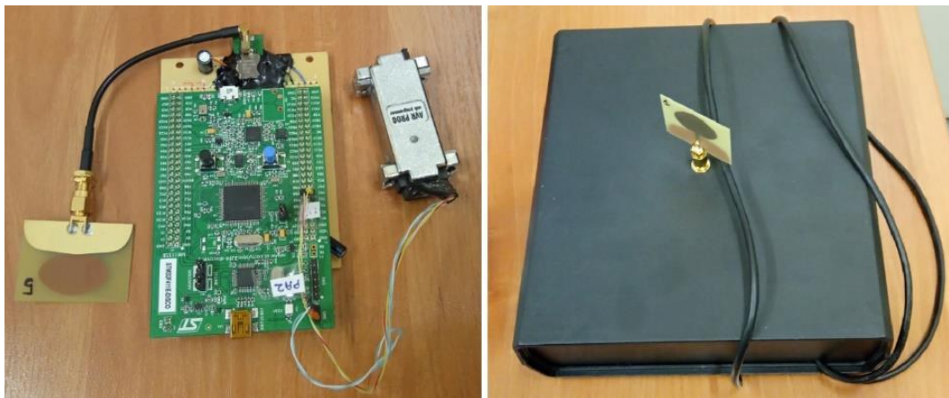
Rys. 26. System bazujący na modułach DWM1000 – po lewej znacznik (tag) służący do akwizycji danych, po prawej punkt referencyjny (anchor) służący jako stacja o stałej zadeklarowanej pozycji.
