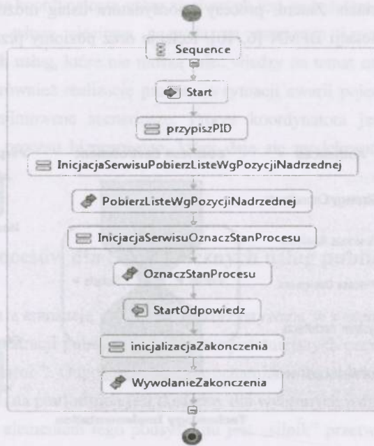
Rys. 4. Reprezentacja graficzna sekwencji zadań procesu BPEL dla platformy ePUAP Fig. 4. Graphic representation of sequence tasks BPEL process for ePUAP platform Źródło: Opracowanie własne na podstawie uruchomionego narzędzia
