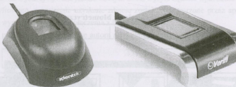
Rys. 4. Przykłady czytników biometrii linii papilarnych – optycznego (po lewej) i pojemnościowego (po prawej)
