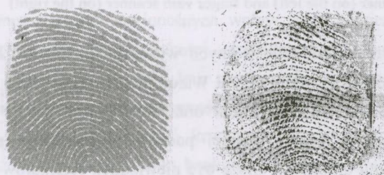
Rys. 6. Wyniki akwizycji surowej charakterystyki w warunkach produkcyjnych – po lewej stronie obraz linii papilarnych pobierany ze zbyt wilgotnej powierzchni, a po prawej – obraz linii papilarnych pobierany z użyciem czytnika o nadmiernie zanieczyszczonej powierzchni
