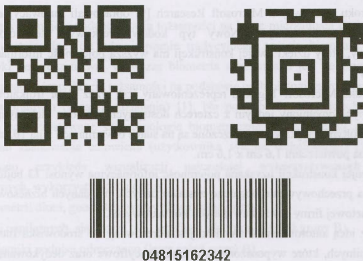
Rys. 1. Przykłady czarno-białych kodów kreskowych – jednowymiarowego i dwuwymiarowych Fig. 1. Examples of black and white bar codes - one-dimensional and two-dimensional
