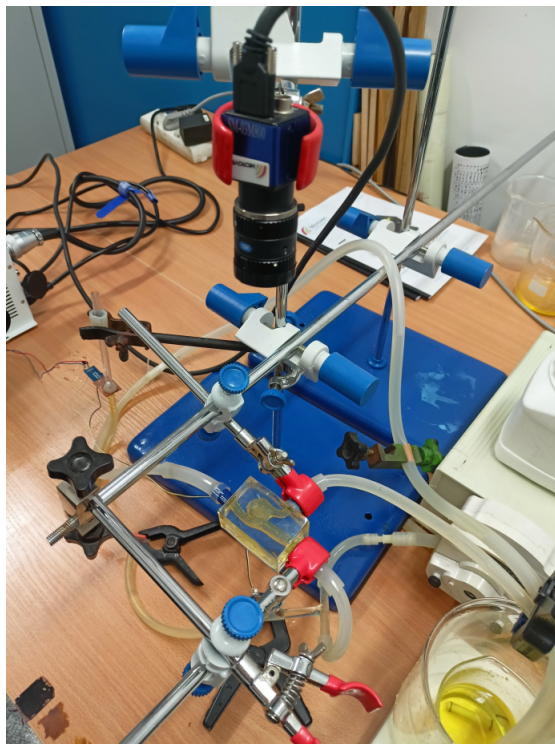
Rysunek 7.2. Fotografia kamery użytej do rejestracji klatek
