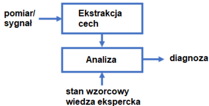
Rysunek 2.13: Schemat ideowy metody wykrywania awarii opartej na analizie sygnału
