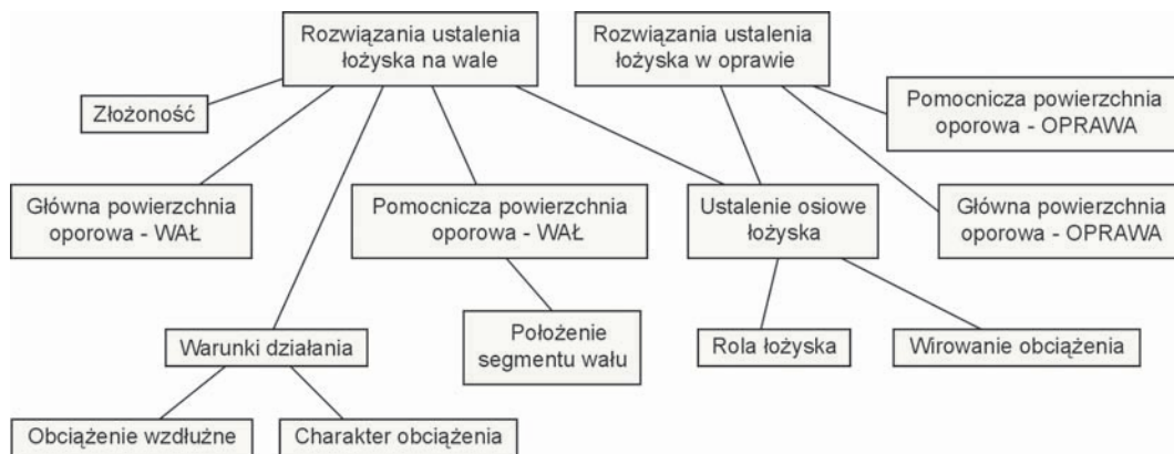
Rys. 6.8. Relacje pomiędzy cechami - ustalenie osiowe łożyska
