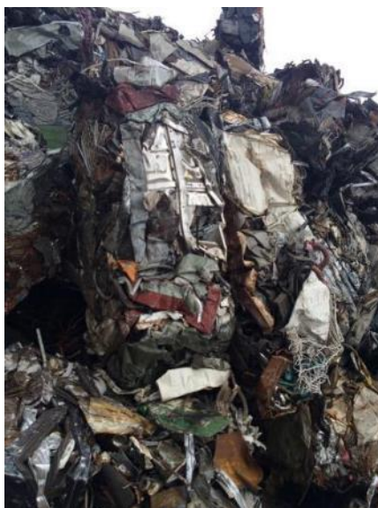
Rys. 4.16 Samochody sprasowane przy pomocy prasy hydraulicznej
