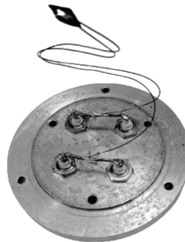
Rys. 3. a) spektroskop impedancyjny, b) przykładowa próbka [opracowanie własne] Fig. 3. a) impedance spectroscopy, b) example of sample [own study]
