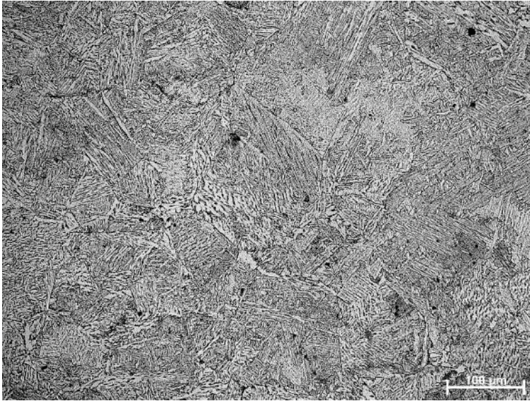
Rys. 22. Widok mikrostruktury spoiny strefy wpływu ciepła zestawu próbek, pow. 200x [opracowanie własne]
