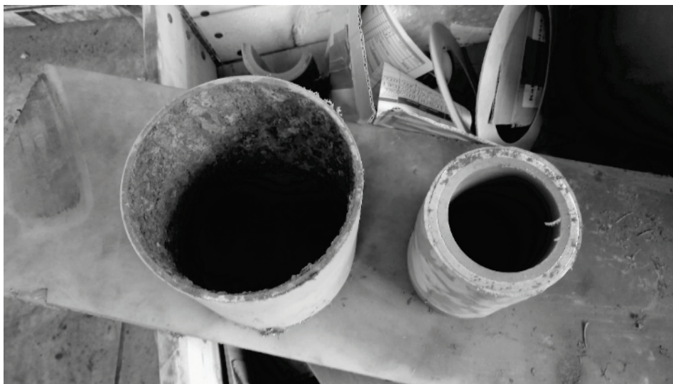
Rys. 4. Porównanie wyglądu wewnętrznych ścianek fragmentów rur. Po lewej stronie rura stalowa bez wykładki, po prawej stronie rura stalowa z wykładką kompozytową [opracowanie własne]
