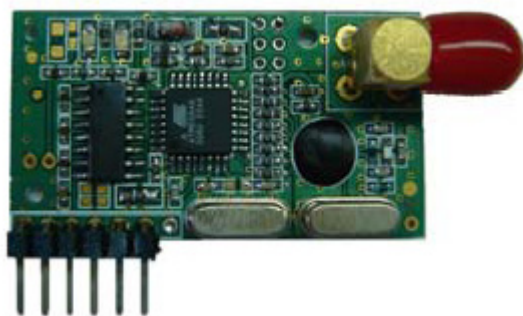
Fig. 2. HM-TR transparent wireless data link module Rys. 2. Moduł do przezroczystej bezprzewodowej transmisji danych HM-TR
