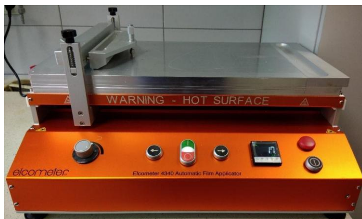
Zdjęcie 2. Automatyczny aplikator filmu membranowego Elcometer 4340 (zdjęcie własne).
