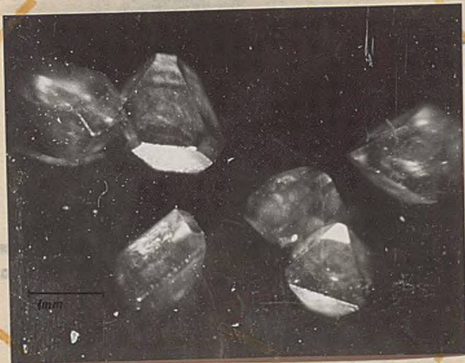
Rys. 20. Kryształy chlorku srebra otrzymane przez bardzo powolną krystalizację z amoniakalnego roztworu przez odparowywanie amoniaku
