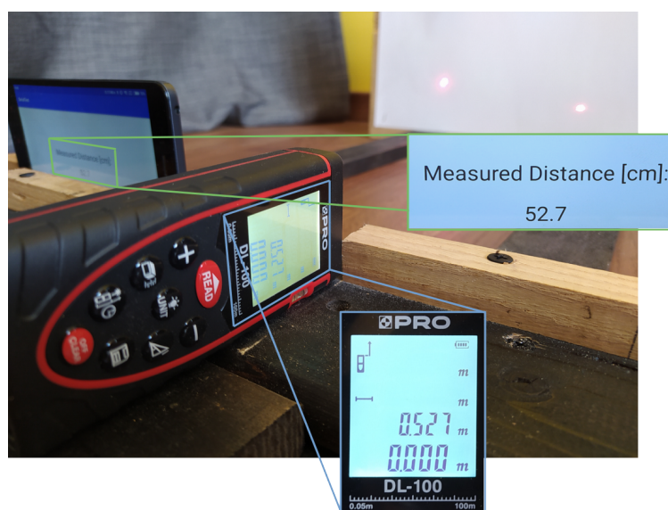
Rys. 50: Przykładowe pomiar urządzeniem pomiarowym i dalmierzem laserowym
