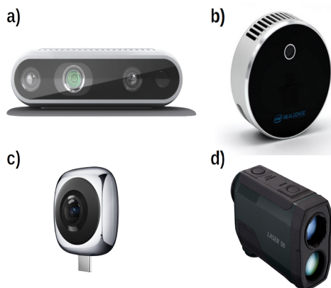
Rys. 45: Sensory i urządzenia peryferyjne umożliwiające ekstrakcję fizycznych wymiarów z obrazu
