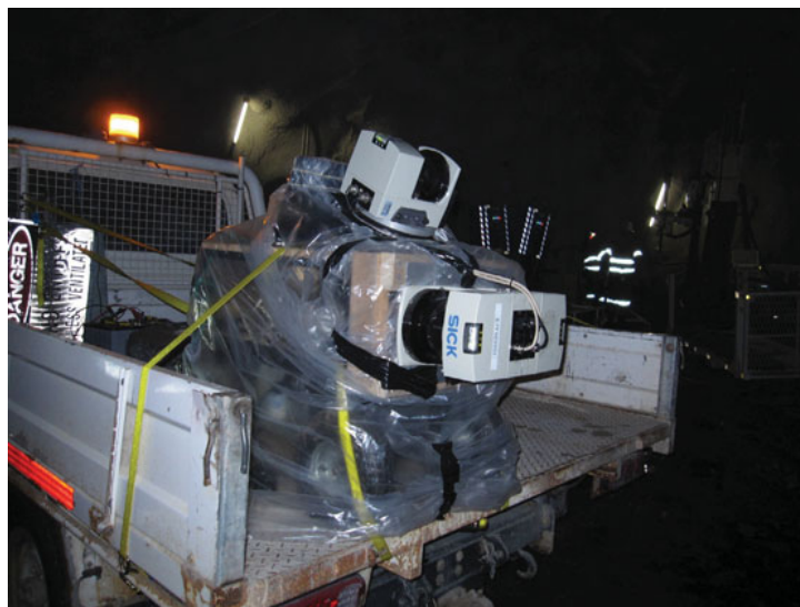
Rys.5. System skanujący przeznaczony do skanowania tuneli kopalnianych, górny skaner jest umieszczony na platformie obrotowej [10]
