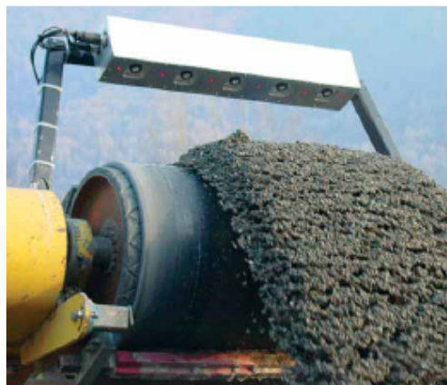
Rys.6. USMS System do pomiaru wolumenu kruszywa przy użyciu czujników ultradźwiękowych [6]
