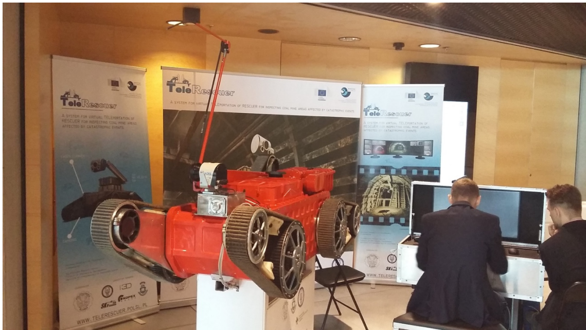
Rys.6. Elementy systemu TeleRescuer: robot mobilny wraz z wyposażeniem oraz stacja operatora (fot. Marcin Januszka)
