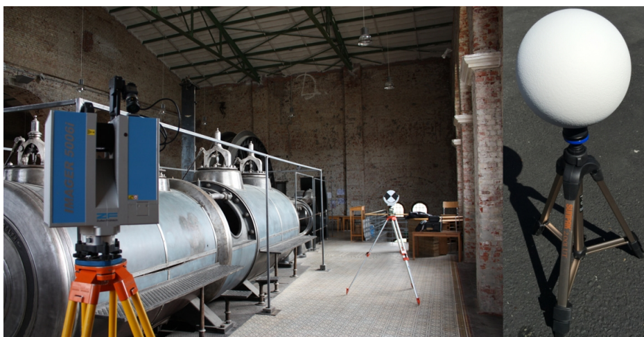
Rys.1. Z lewej skaner Z+F Imager 5006i wraz z wskaźnikiem pomiarowym w kształcie tarczy [2], z prawej wskaźnik pomiarowy w kształcie kuli [3]
