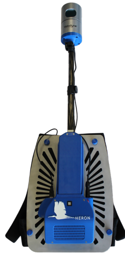
Rys.6. Przenośne urządzenie skanujące w formie plecaka Heron AC-1, wykorzystujące skaner 3D Velodyne HDL-32E [12]
