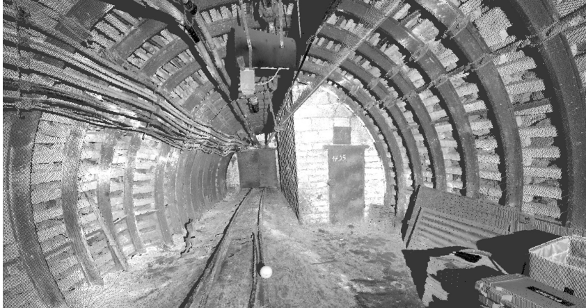
Rys.9. Chmura punktów przedstawiająca wyrobisko górnicze, uzyskana metodą naziemnego skaningu laserowego [19]
