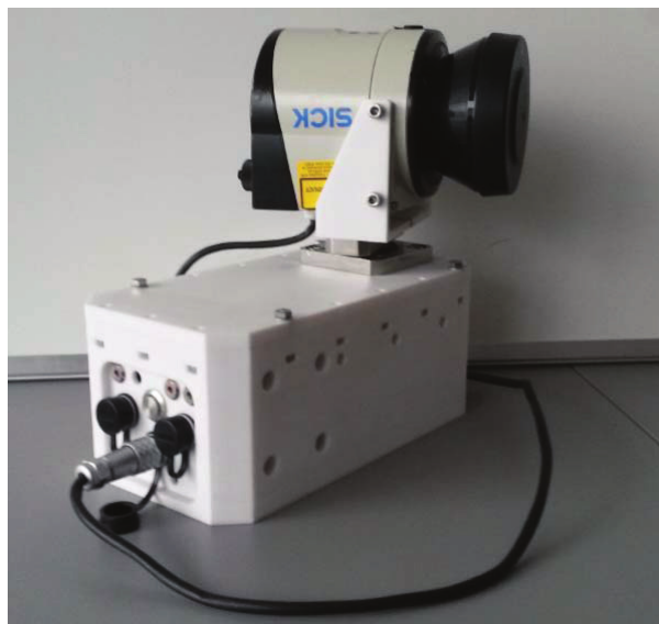
Rys.2. Prototyp urządzenia skanującego stosowanego w projekcie TeleRescuer, zbudowanego ze skanera 2D LMS111 zamontowanego na obrotowej platformie [5]
