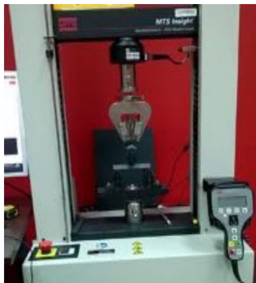
Rys. 6.33. Maszyna wytrzymałościowa MTS Insight 10 przygotowana do testów
