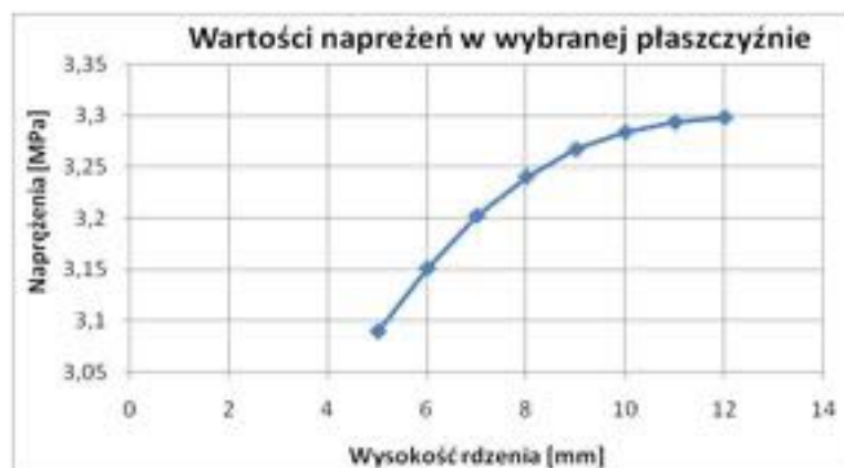
Rys. 5.37 Wartości maksymalnych naprężeń redukowanych w płaszczyźnie oddalonej o 1 mm od podstawy modelu
