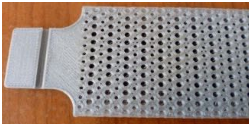
Rys. 8.19 Wytworzony element (druk 3D), struktura jednowarstwowa, grubość 5 mm, przekrój podłużny, powiększony fragment w strefie otworu dla sworznia
