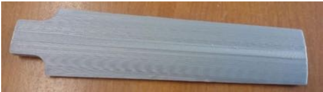
Rys. 8.16 Wytworzony element (druk 3D), struktura jednowarstwowa wersja 1, grubość 5 mm, widok od strony zewnętrznej
