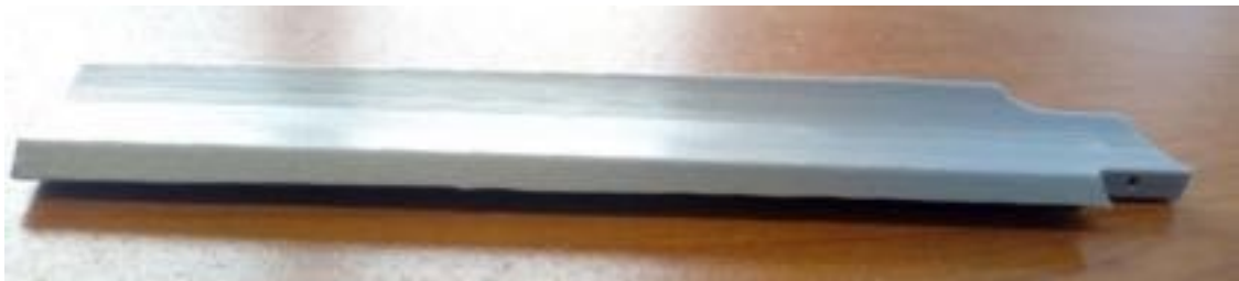
Rys. 8.17 Wytworzony element (druk 3D), struktura jednowarstwowa wersja 1, grubość 5 mm, widok od strony wewnętrznej
