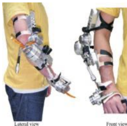
Rys. 8.1 Prototyp egzozszkieletu WOTAS do kontroli ruchu przedramienia, widok z boki i z przodu [92]
