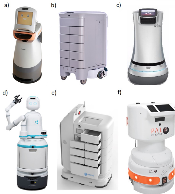
Rys. 5.1. Roboty mobilne do rozwożenia leków na terenie szpitala: a) HOSPI-R Panasonic [7], b) TUG Aethon [2], c) Relay Swisslog [8], d) Moxi Diligent Robotics [6], e) TmiRob [12], f) TIAGO Delivery [5]
