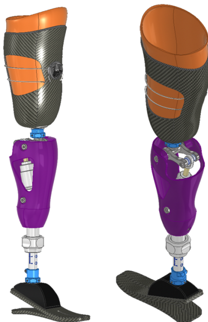
Rys. 4.11. Model CAD protezy kończyny dolnej dla dziecka
