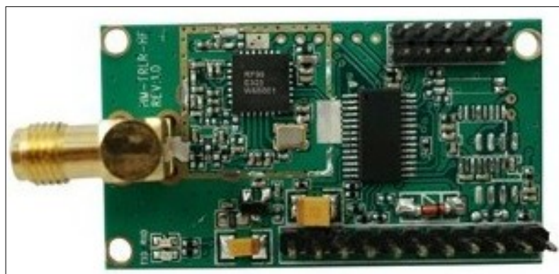
Rysunek 66. Moduł komunikacji HM-TRLR-D Series 100mW. Źródło: [70].
