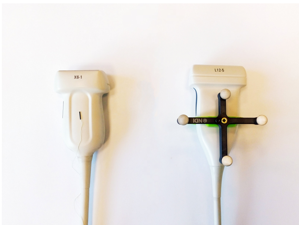
Rys. 3.6: Porównanie znaczników systemów elektromagnetycznego Aurora (lewa strona) i optycznego Polaris (prawa strona).
