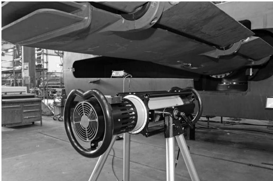
FIGURE 37: GAS-FILLED TUBE HEAD X-RAY EMITTER [56]
