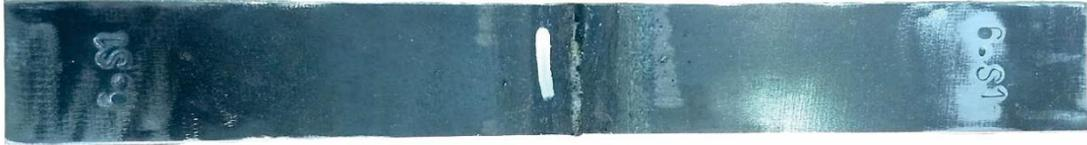
FIGURE 88: SAMPLE FOR BEND TEST OBTAINED FROM SSA3 PIPE
