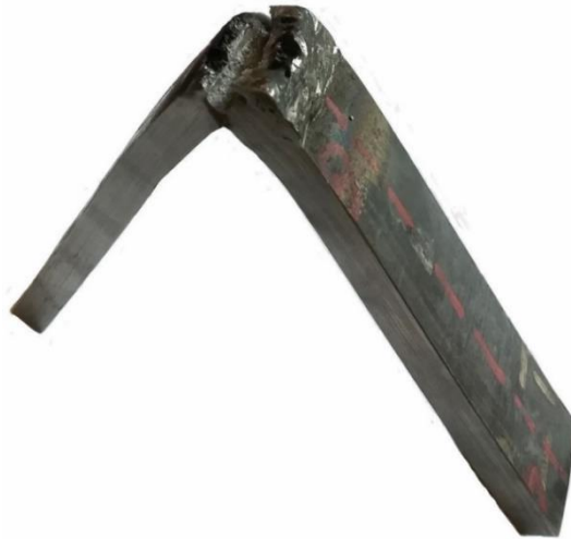
RYSUNEK 3: USZKODZENIE PRÓBKII 4_G2
