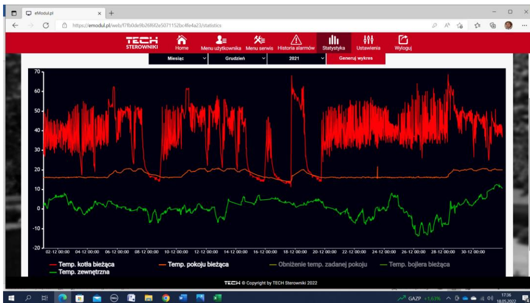
Rys.9. Przykładowe dane pomiarowe pobrane z aplikacji eModul w zakładce Statystyki dla a) temperatura kotła bieżąca, temperatura pokoju bieżąca i temperatura zewnętrzna: grudzień 2021, b) marzec 2022
