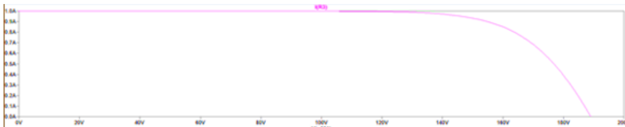
Rys. 6. Charakterystyka zewnętrzna zasymulowanego komputerowo modułu PV przy prądzie źródła równym 1 A
