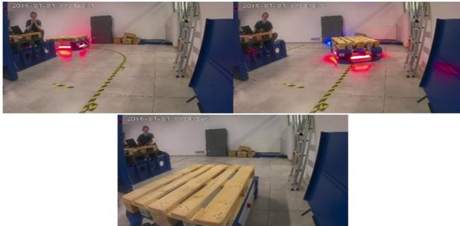
Rys. 9. Przebieg testu jazdy po łuku
