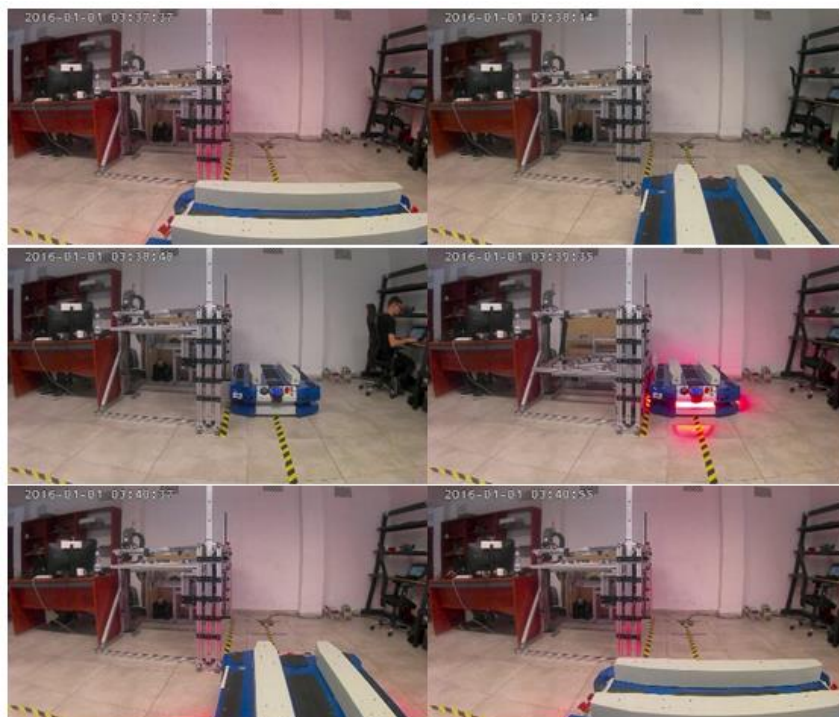
Rys. 11. Przebieg testu dokowanie SAWA
