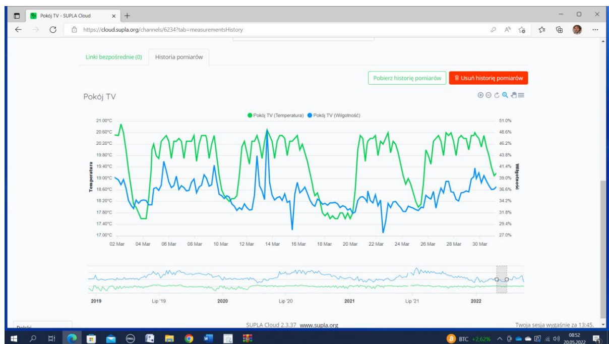
Rys. 10. Przykładowe dane pomiarowe pobrane z chmury SUPLA.ORG dla: a) temperatura na wejściu rozdzielacza marzec 2022, b) temperatura i wilgotność w pokoju telewizyjnym marzec 2022
