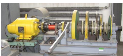
Rys. 10. Stanowisko pomiarowe umożliwiające zmianę momentu bezwładności elementów wirujących sprzężonych z wałem silnika
