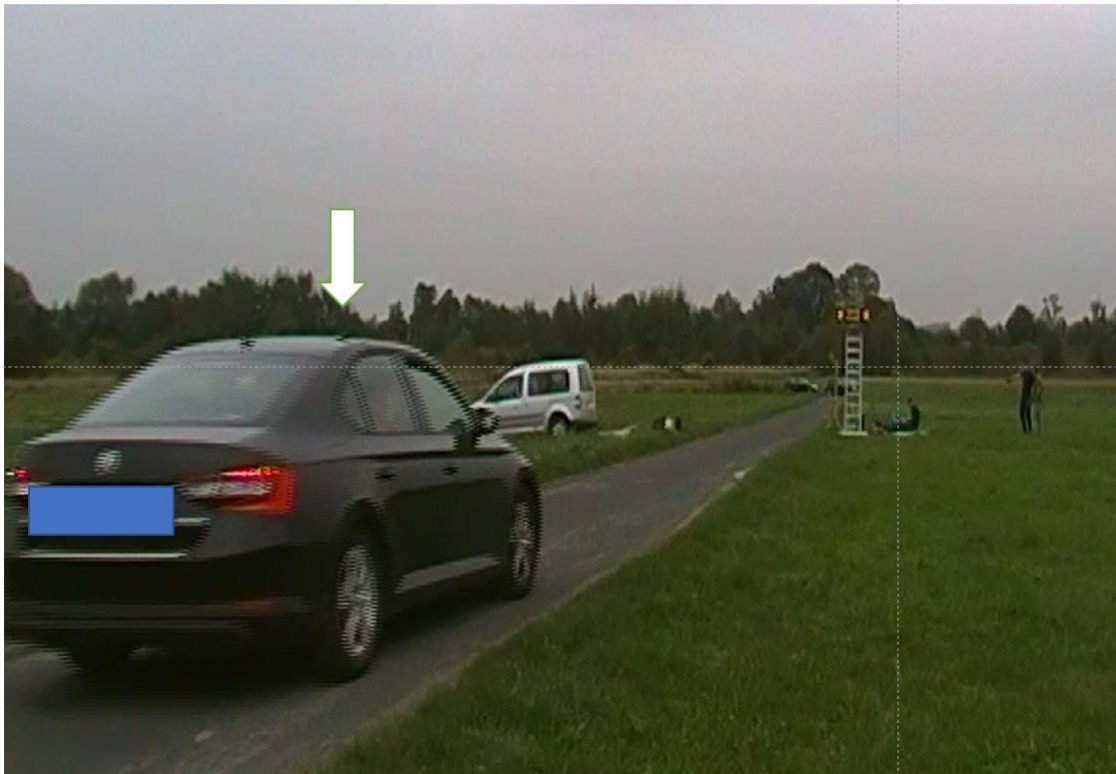
Rys. 65. Pojazd testowy z zainstalowanym na dachu odbiornikiem GPS
