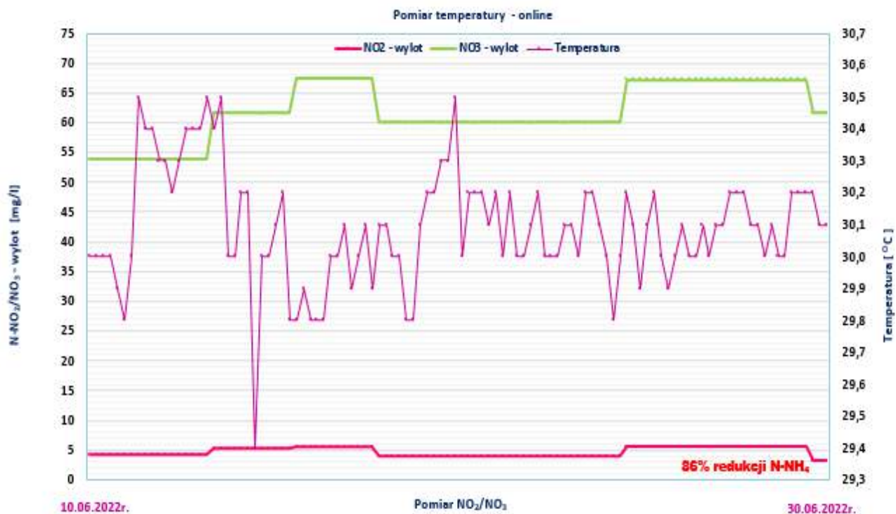
Wykres 32. Stężenie azotu azotynowego i azotanowego w procesie deamonifikacji na odpływie z bioreaktora ANITA™Mox® w odniesieniu do temperatury prowadzonego procesu – Seria II Faza III
