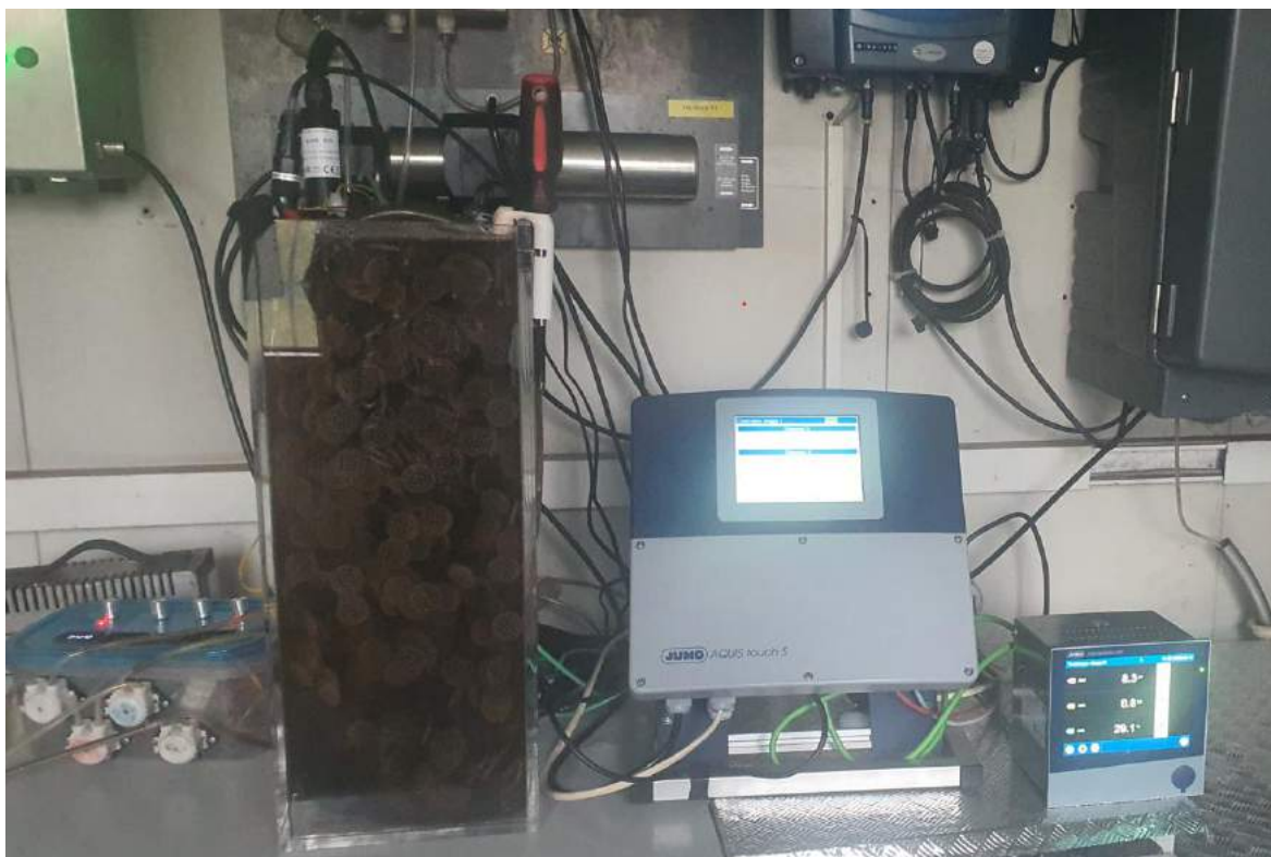
Zdjęcie 10. Laboracyjne stanowisko usuwania azotu z odcieków w technologii ANITA™Mox®
