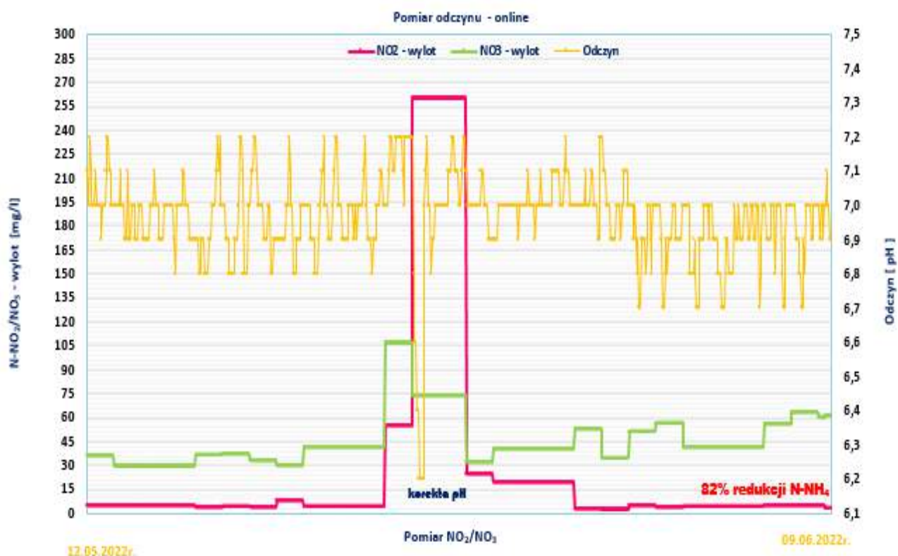
Wykres 28. Stężenie azotu azotynowego i azotanowego w procesie deamonifikacji na odpływie z bioreaktora ANITA™Mox® w odniesieniu do pH prowadzonego procesu – Seria II Faza II
