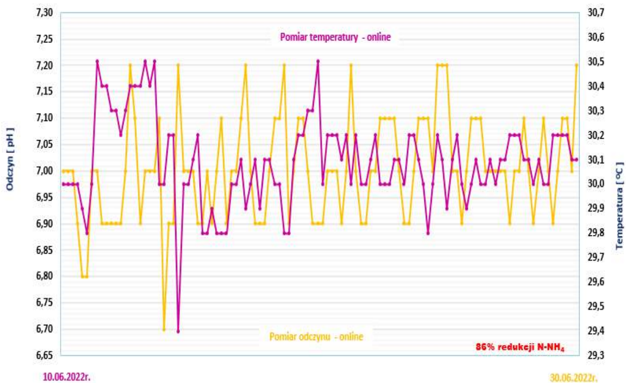
Wykres 39. Zmiany wartości pH i temperatury w procesie ANITA™Mox® – Seria II Faza III (86% usunięcia azotu amonowego)
