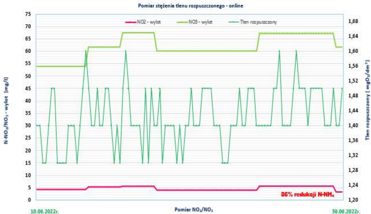
Wykres 33. Stężenie azotu azotynowego i azotanowego w procesie deamonifikacji na odpływie z bioreaktora ANITA™Mox® w odniesieniu do stężenia tlenu rozpuszczonego prowadzonego procesu – Seria II Faza III
