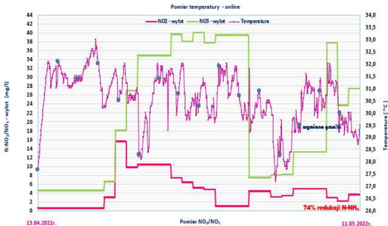
Wykres 26. Stężenie azotu azotynowego i azotanowego w procesie deamonifikacji na odpływie z bioreaktora ANITA™Mox® w odniesieniu do temperatury prowadzonego procesu – Seria II Faza I
