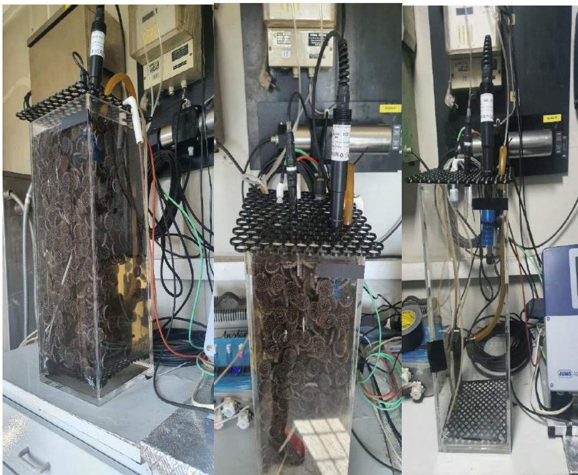
Zdjęcie 9. Laboratoryjny model reaktora MBBR ANITA™Mox®
