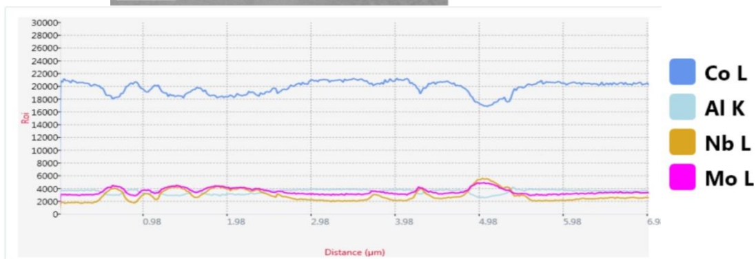
Rys.24. Analiza liniowa EDX pojedynczych wydzieli w strukturze pierwotnej nadstopu na osnowie kobaltu typu CoAlMoNb, obserwacja w mikroskopie skaningowym SEM
