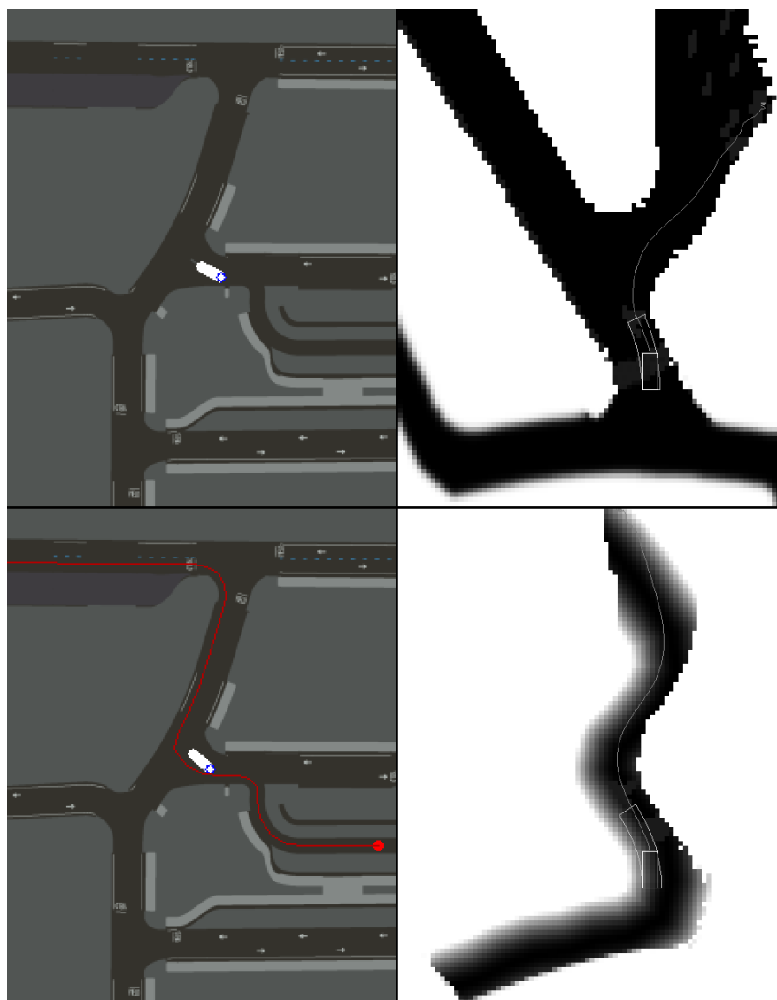
Rysunek 7.1. Wizualizacja siatki oporów przed (górny rząd) oraz po (dolny rząd) nałożeniu dodatkowej warstwy komórek nieprzejezdnych ograniczających wyznaczanie trajektorii przejazdu algorytmu CFF do ścieżki prowadzącej do wskazanego celu podróży
