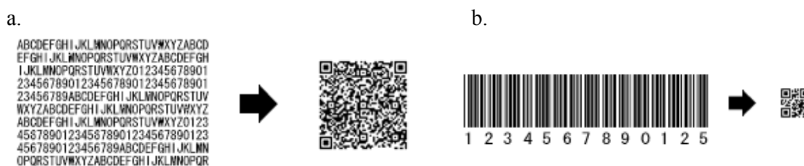
Rys. 3. Najważniejsze zalety QR Code: a) duża pojemność kodowania - zakodowanie 300 znaków alfanumerycznych oraz b) mały obszar drukowania - porównanie wielkości przy kodowaniu tej samej informacji
