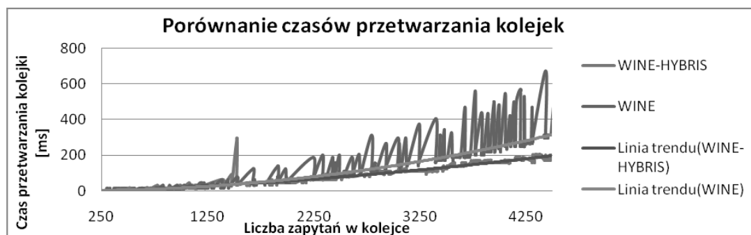
Rys. 6. Zależność czasu przetwarzania do liczby zapytań w kolejce w algorytmach WINE i WINE-HYBRIS
