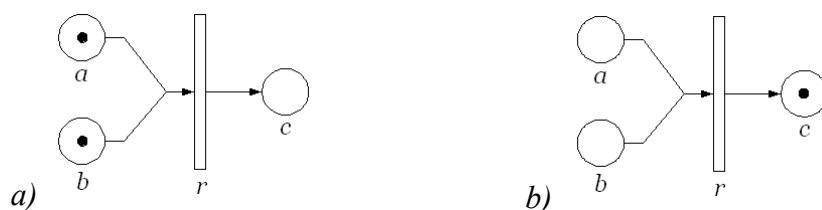
Rys. 2. Aktywowanie reguły jako aktywowanie tranzycji Fig. 2. The activation of the rule as rule's firing
