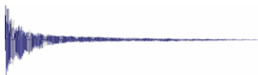
Rys. 1. Przykład wykresu postaci czasowej czystego dźwięku a 1 gitary elektrycznej
