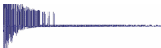
Rys. 2. Przykład wykresu postaci czasowej dźwięku a 1 gitary elektrycznej przesterowanego efektem fuzz
