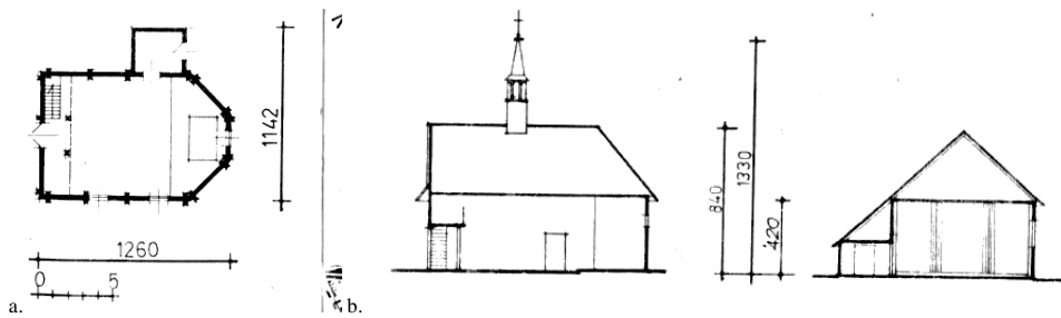
Archiwalne plany kościoła z 1653 r.: a. schemat rzutu, b. schemat elewacji południowej oraz przekroju poprzecznego [KE_059]
