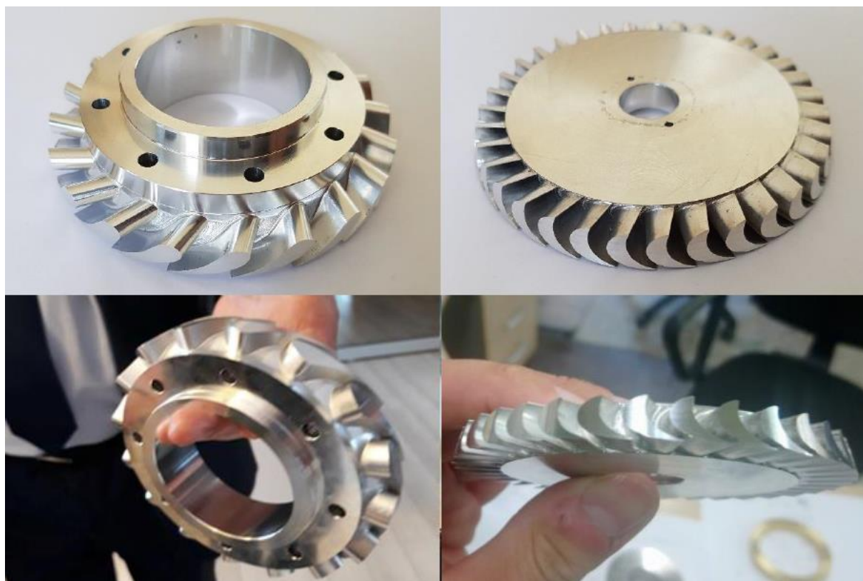
Rysunek 5.4. Kierownica i wirnik turbiny Marani ORC10 oraz ich rozmiar w porównaniu do dłoni. Liczba łopatek kierownicy: 20; Liczba łopatek wirnika: 35
