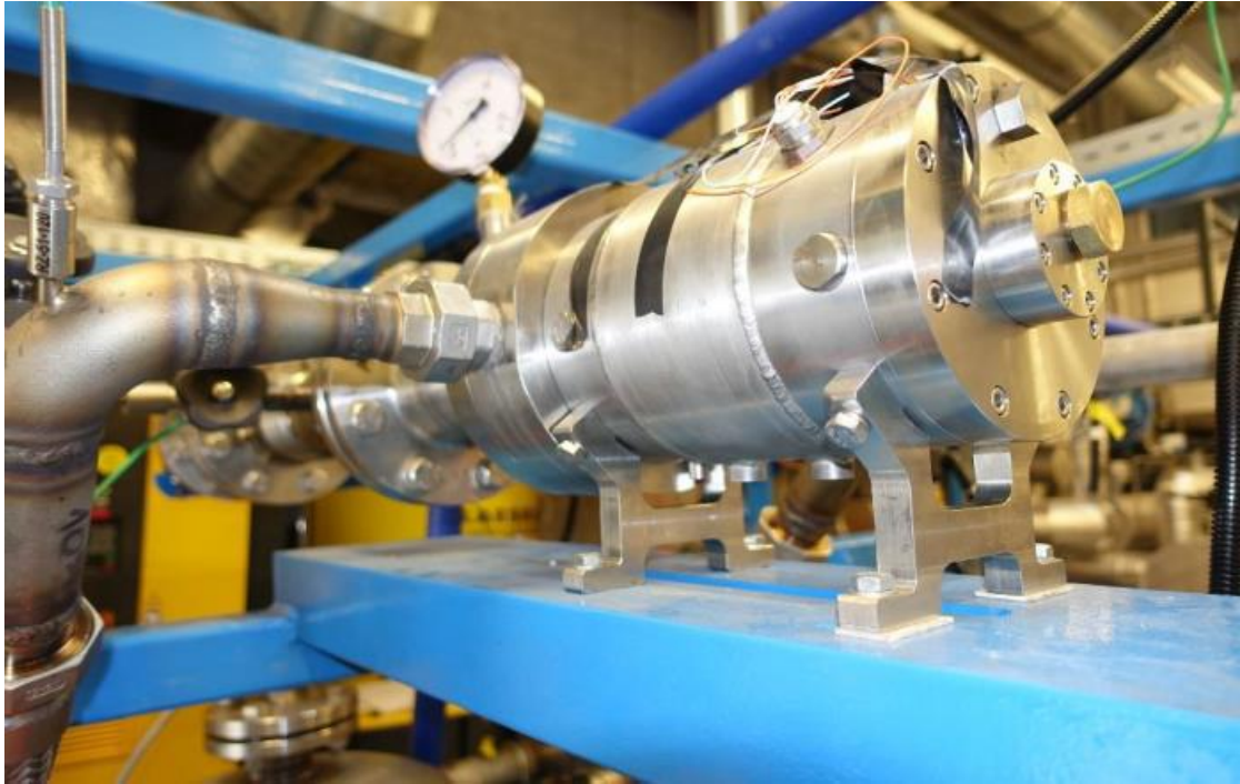
Rysunek 5.5. Turbina zamontowana w prototypie Marani ORC10 w trakcie testów wewnętrzzakładowych
