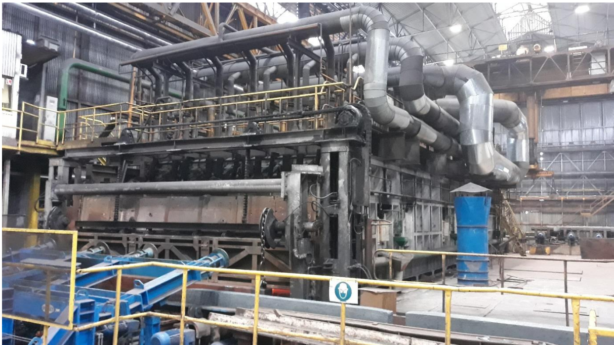
Rysunek 1.3 Piec pokroczny w walcowni rur
