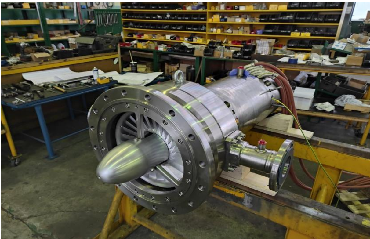
Rysunek 5.14. Zmontowana turbina dla układu ORC300 przed testami na sprężonym powietrzu
