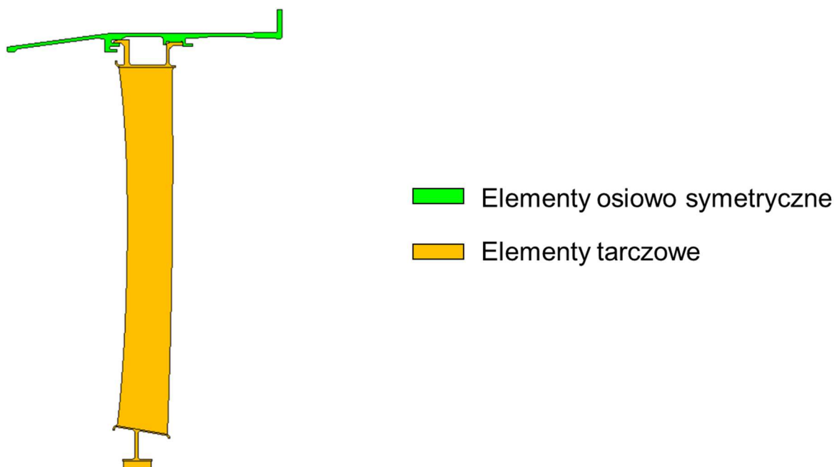
Rysunek 30. Podział modelu numerycznego ze względu na typ elementu skończonego
