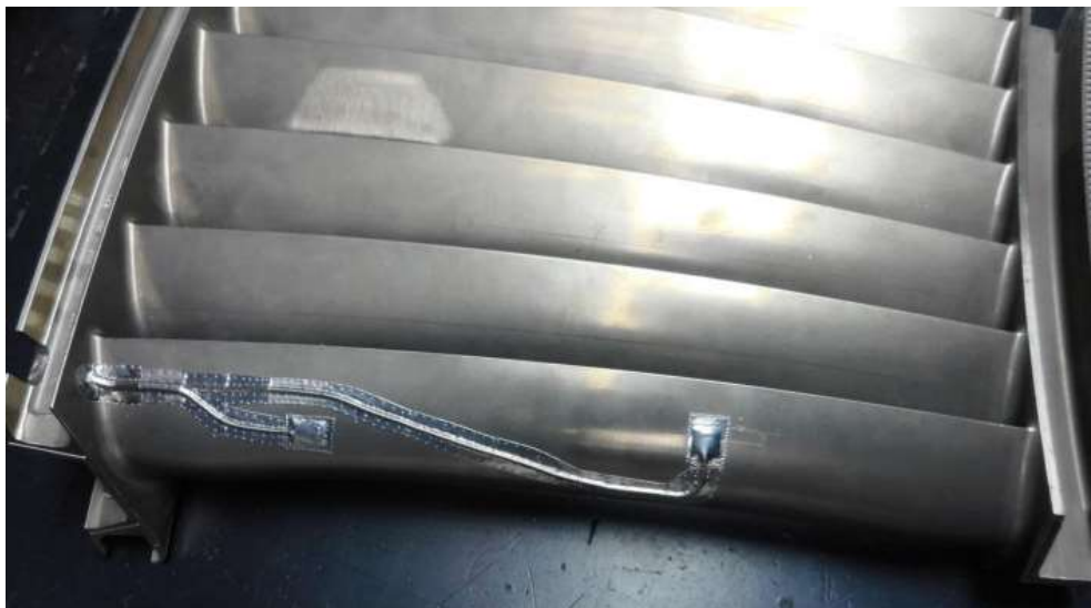
Rysunek 13. Stator wraz z zaaplikowanymi tensometrami
