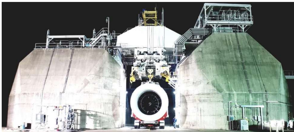
Rysunek 14. Stanowisko testowe dla testu certyfikacyjnego silnika turbowentylatorowego [GE Aviation]
