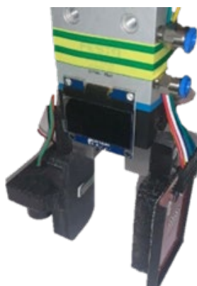
Rys. 3. Prototypowa wersja końcówek chwytanych wraz z czujnikami, zamontowana na chwytaku (opracowanie własne)
