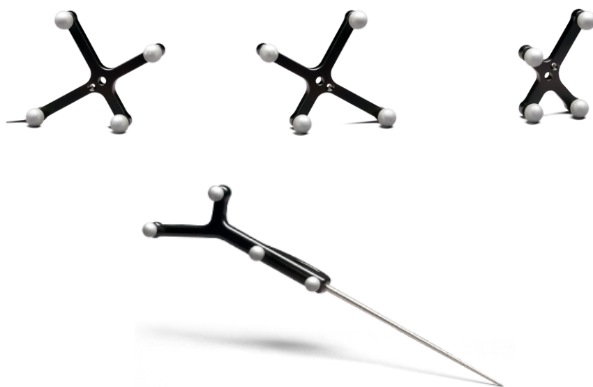
Rys. 1.9: Znaczniki optyczne służące do śledzenia narzędzi w systemie NDI Polaris [79]. Dzięki unikalnemu układowi geometrycznemu markerów sferycznych możliwe jest jednoznaczne zidentyfikowanie znacznika. Na dolnym obrazie przedstawiono wskaźnik niezbędny do przeprowadzenia procedury kalibracji.
