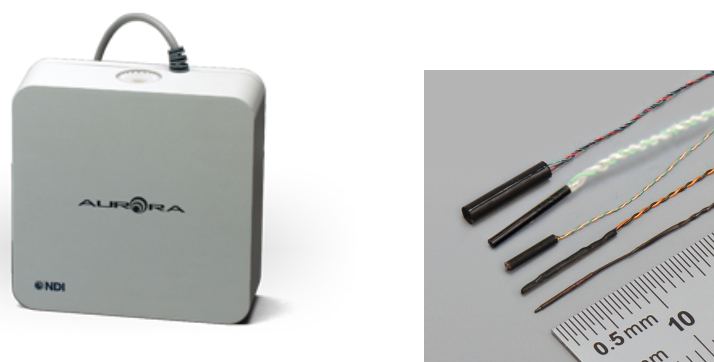
Rys. 1.11: System elektromagnetyczny NDI Aurora. Po lewej stronie zdjęcie generatora pola elektromagnetycznego, po prawej czujniki zaburzające to pole, dzięki czemu możliwa jest ich precyzyjna lokalizacja w przestrzeni [79].
