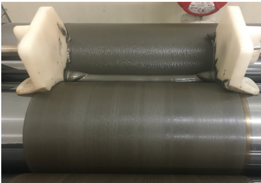
Rysunek 26 Drugi etap homogenizacji - walcowanie. Widok na szczelinę pierwotną.
