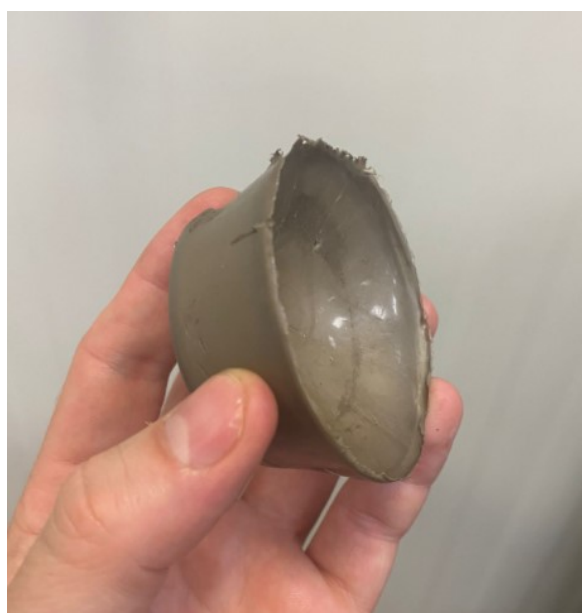
Rysunek 2 Kopolimer etylenu i octanu winylu domieszkowany mikrometrycznym proszkiem srebra płatkowego. Stan przed usieciowaniem. Widoczny brak płaskorównoległości (charakterystyczny lej).
