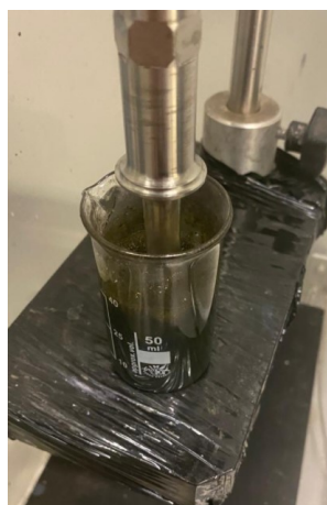
Rysunek 22 Próbka kompozycji w trakcie homogenizacji in-situ przy pomocy sonikatora. Sonotroda S24d14D.
