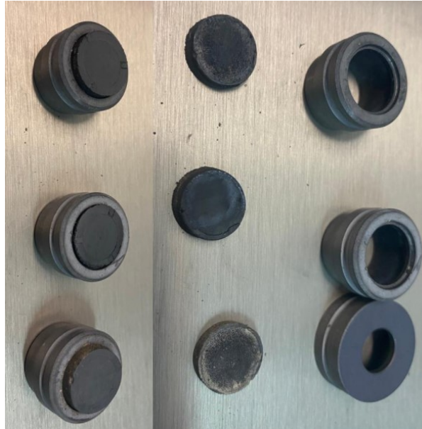
Rysunek 57 Próbki kompozytów w czasie próby LFA. Po lewej - próbki w holderach SiC przed pomiarem. Po prawej - wyjęte z holderów próbki z widoczną degradacją.
