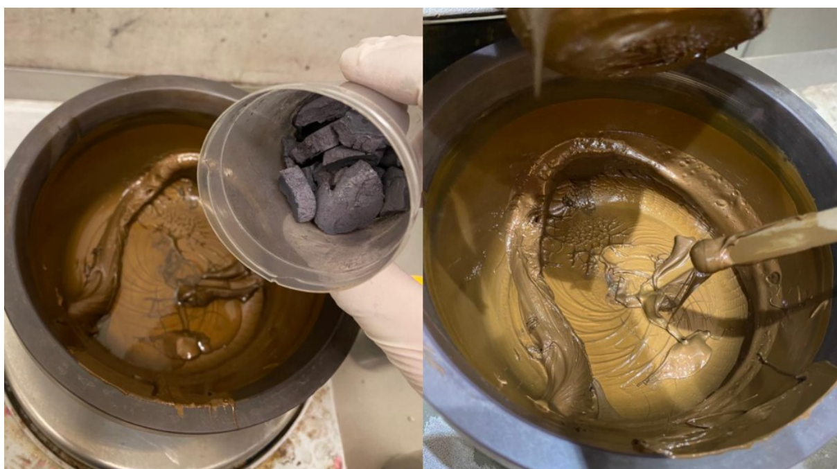
Rysunek 25 Misa agatowa z macierzą oraz dopantem. Po lewej widok z materiałem wsadowym. Po prawej w trakcie homogenizacji. Widoczne drobne złoże materiałowe
