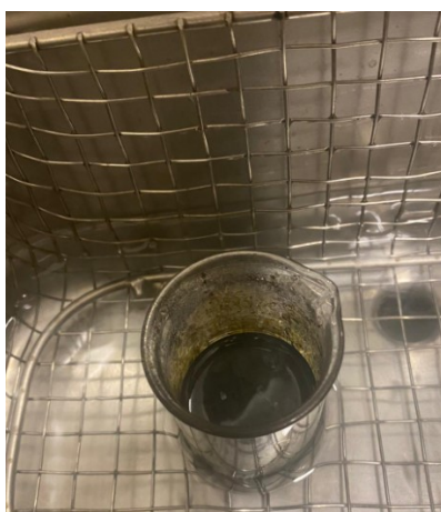
Rysunek 21 Próbką kompozycji w trakcie homogenizacji ex-situ za pomocą płuczki ultradźwiękowej Ultron U-504.
