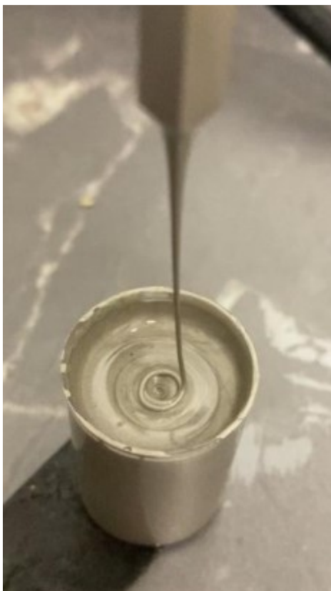
Rysunek 4 Kauczuk silikonowy RTV2 z dodatkiem mikrometrycznego proszku srebra płatkowego w czasie badań reologicznych.
