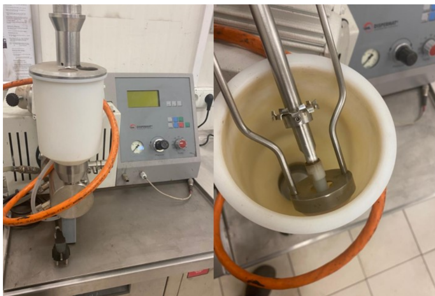
Rysunek 24 Młyn perłkowy. Po lewej - widok na całość urządzenia. Po prawej - kielich pierwszej fazy homogenizacji z widocznym układem mieszającym.
