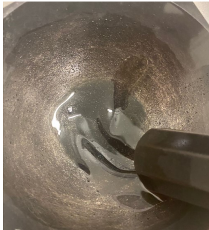
Rysunek 19 Homogenizacja prosta, ręczna z wykorzystaniem móżdżierza. Widoczne rozwarstwienie na poziomie dopant-macierz oraz wytrącenie srebra metalicznego.
