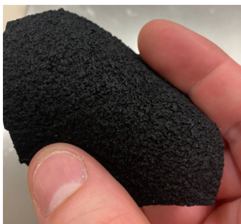
Rysunek 8 Niepoprawna struktura kompozycji z wykorzystaniem GO.
