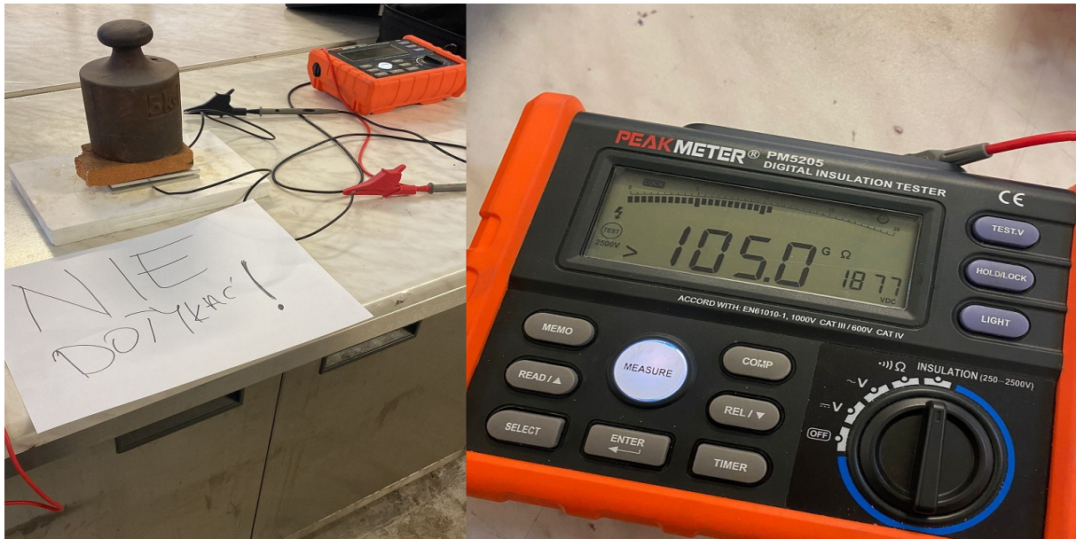
Rysunek 67 Układ pomiarowy. Po lewej układ w czasie pomiaru z widocznym obciążnikiem oraz napiętymi zaciskami. Po prawej wyświetlacz urządzenia z widoczną wartością rezystancji mierzonej na obwodzie.
