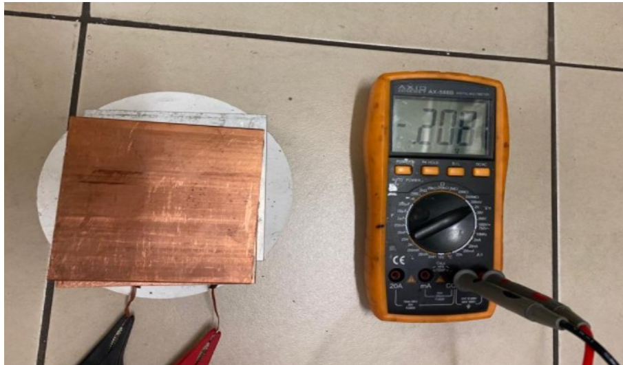
Rysunek 74 Pomiar modułu termoelektrycznego. Moduł z dodatkiem kompozytu nAgtoSF 50% . Widoczny wartość uzyskanego napięcia.
