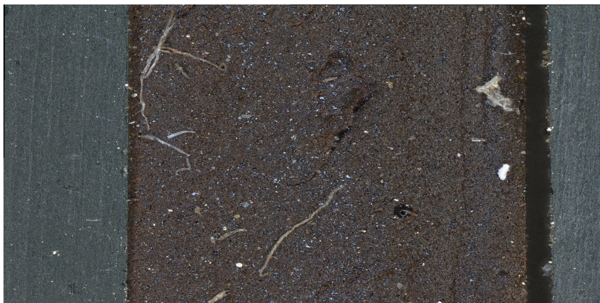
Rysunek 43 Zdjęcie mikroskopowe obserwowanego przekroju badanej próbki. Widoczne cząstki, aglomeraty oraz zanieczyszczenia (włókna). Próbka nAg 40%wt.
