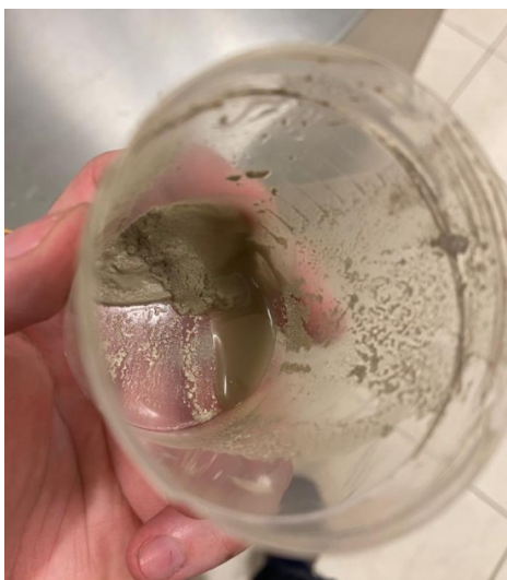
Rysunek 16 Kompozyt RTV2 z dodatkiem SS. Widoczne rozwarstwienie macierzy od wsadu materiałowego.
