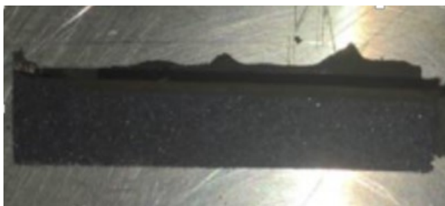
Rysunek 20 Usieciowana kompozycja termoprzewodząca. Widoczne zaburzenie stężenia materiału.
