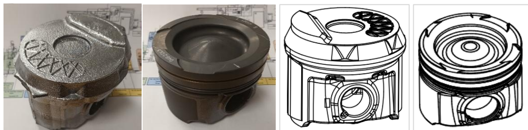
Rys.2.1. Przykładowe odlewy tłoków ze stopów Al-Si produkowane w F-M Gorzyce:
