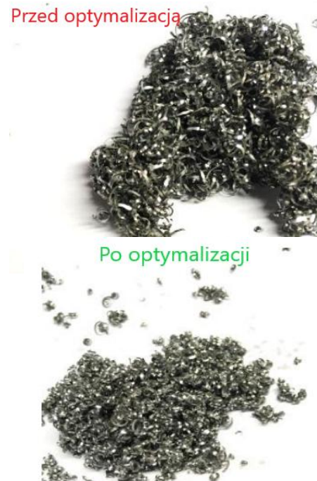
Rys.5.56. Wióry podczas obróbki mechanicznej odlewów tłoków: a) blokujące podajnik odprowadzający oraz zalegające na oprzyrządowaniu mocującym tłoka; b) przed i po optymalizacji polegającej na zastosowaniu tzw. „łamaczy wiórów”.
