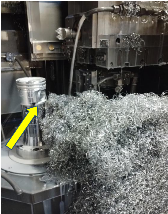
Rys.5.56. Wióry podczas obróbki mechanicznej odlewów tłoków: a) blokujące podajnik odprowadzający oraz zalegające na oprzyrządowaniu mocującym tłoka; b) przed i po optymalizacji polegającej na zastosowaniu tzw. „łamaczy wiórów”.
