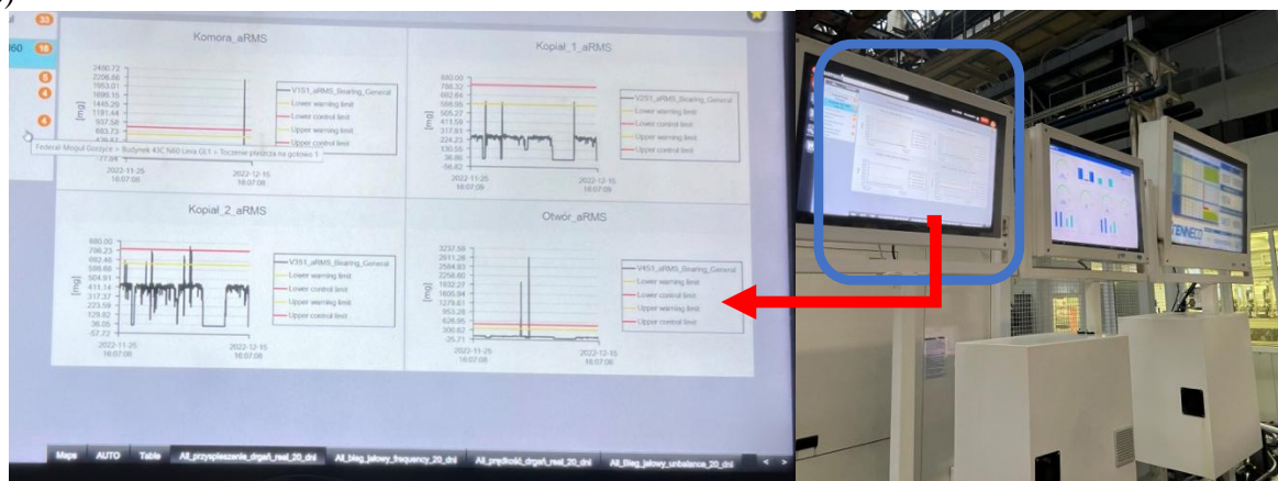
Rys. 5.69. Systemy kontrolne Andon: a) legenda opisująca sygnały świetlne; b) system monitorujący drgania wybranych części maszyny linii DL9.
